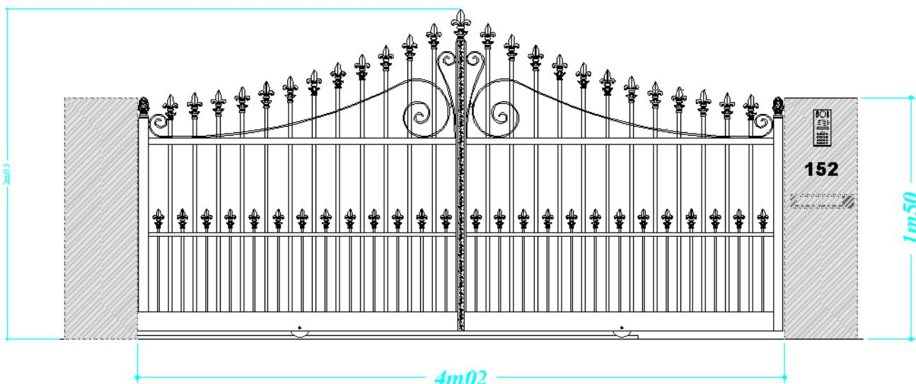
Exécution sur mesures : possible jusqu'à 15m00 Lg - Hauteur au choix
